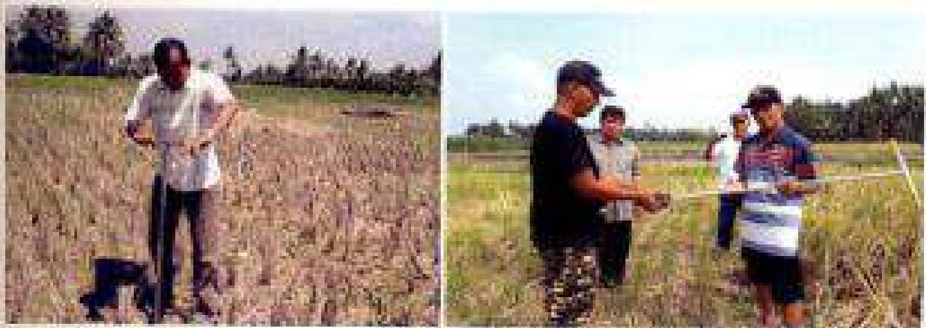
Gambar 4.1 Pengambilan Contoh Tanah Menggunakan Alat Bor Tanah Mineral
