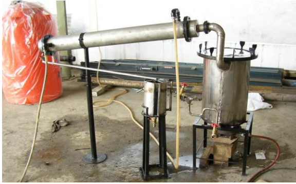
Gambar 27. Penyuling minyak atsiri berkapasitas 50 liter
